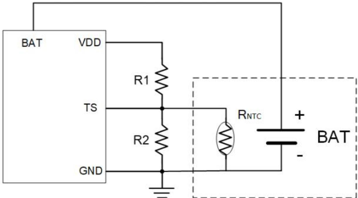
HM5056 将 TS 管脚的电压同芯片内部的两个阈值 OTPL 和 OTPH 相比较, 以确认电池的温度是否超出正常范围。在 HM5056 内部, OTPL 被固定在  $45\% \times VDD$ , OTPH 被固定在  $80\% \times VDD$ 。如果 TS 管脚的电压  $V_{TS} < OTPL$  或者  $V_{TS} > OTPH$ , 则表示电池的温度太高或者太低, 充电过程将被暂停; 如果 TS 管脚的电压  $V_{TS}$  在 OTPL 和 OTPH 之间, 充电周期则继续。
